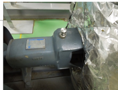
【振動加速度ピックアップ】 (軸受上部 Z軸方向) リオン製PV-41 せん断型、1.09mV/m/s 2 3Hz~10kHz
